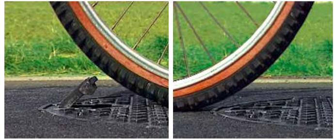
Der **T-BLOC** ist ein in den Deckel integrierter Griff, der gleichzeitig als Öffnungshilfe und Verriegelung des Deckels dient. Die Entriegelung erfolgt mit Baustellen üblichem Werkzeug und ist auch bei starker Verschmutzung und Frost problemlos möglich.
