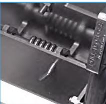
Capots **articulés et ouverture assistée** par ressorts de torsion, réduisant l'effort de levage à moins de 25 kg
