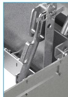
Capots **articulés et ouverture assistée** par ressorts de torsion, réduisant l'effort de levage à moins de 25 kg
