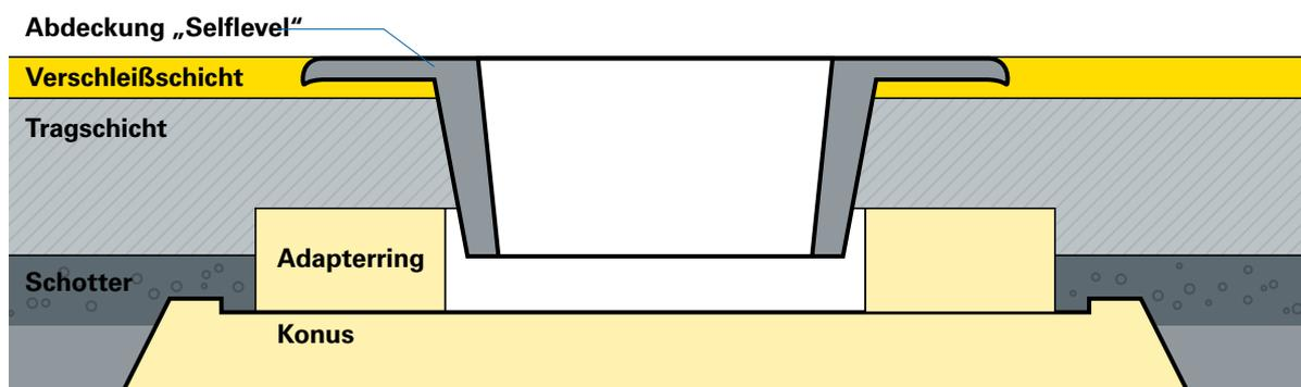
Einbauprinzip einer selbstnivellierenden Schachtabdeckung
